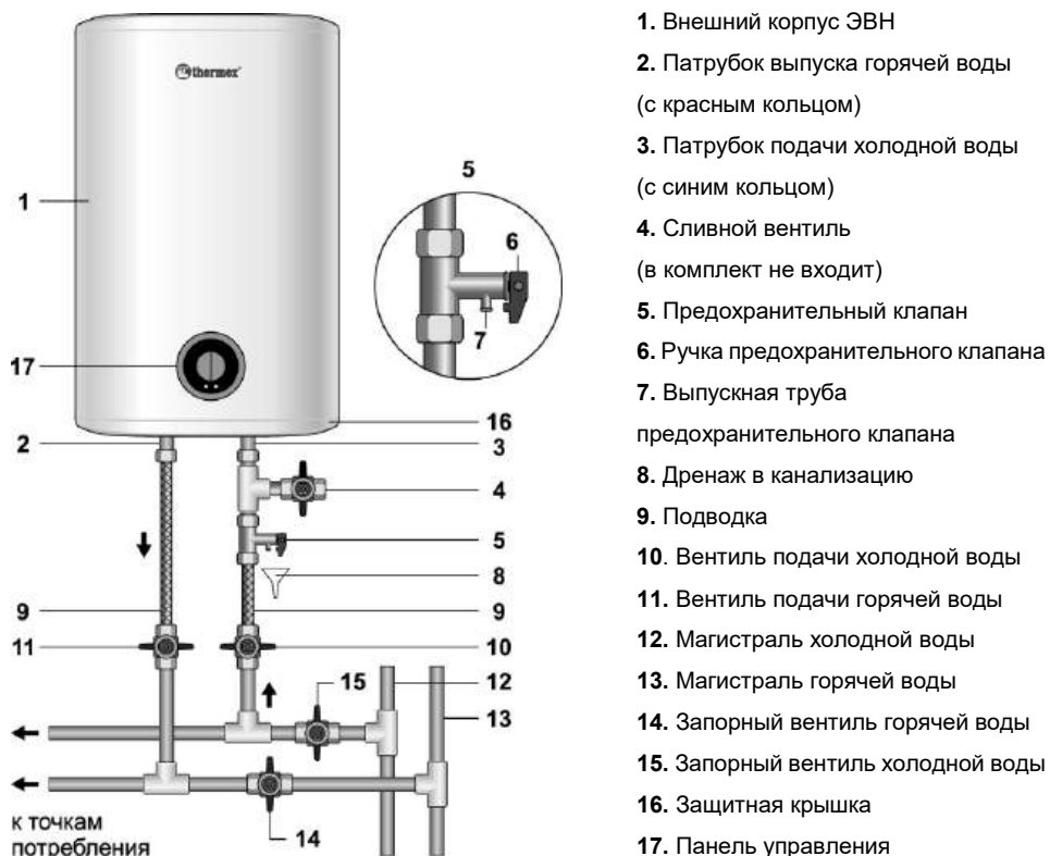
Рисунок 2. Схема подключения ЭВН к водопроводу
