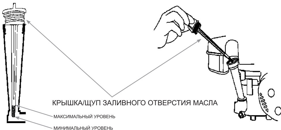
Рис. 6 Уровень масла в картере двигателя
