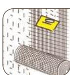
Раствор наносится зубчатым шпателем из нержавеющей стали (размер зуба 10–12 мм) на всю поверхность теплоизоляционной плиты. Перед созданием базового штукатурного слоя минеральные плиты грунтуются тонким слоем клеевого раствора. В свежий слой клеевого раствора укладывается армирующая щелочестойкая стеклосетка (например, **vetonit facade 2000**) и утапливается в клеевой раствор. Необходимо разгладить клеевой раствор, пропустивший через ячейки, не дожидаясь заветривания поверхности.
