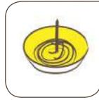
Залить в емкость 4,5–5,25 литра чистой воды и засыпать 25 кг (мешок) смеси **vetonit facade R200 winter**. Рекомендуемая температура воды +20 °C. Запрещено использовать воду с температурой выше +35 °C. Перемешивать раствор необходимо механическим способом при помощи дрели-миксера со средней скоростью 400–600 об/мин до достижения однородной консистенции без комков, в течение 3–5 минут.
